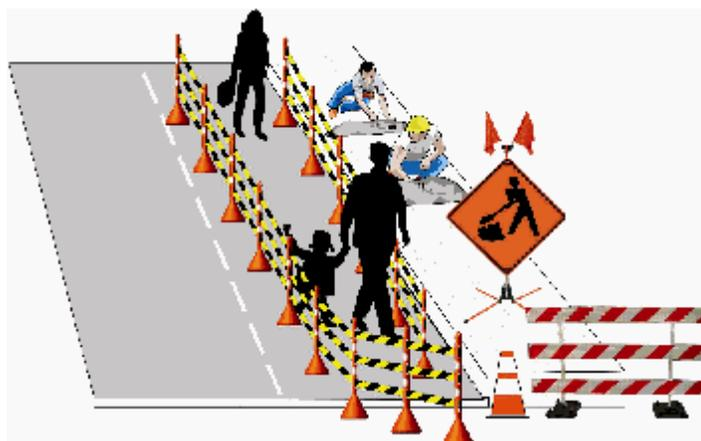
Cuando se adelanten labores de excavación en el frente de obra se debe aislar totalmente el área excavada (delimitar el área con cinta) y fijar avisos preventivos e informativos que indiquen la labor que se está realizando. Para excavaciones con profundidades mayores a 50 cm, la obra debe contar con señales nocturnas reflectantes o luminosas, tales como conos luminosos, flashes, licuadoras, flechas, ojos de gato o algún dispositivo luminoso
